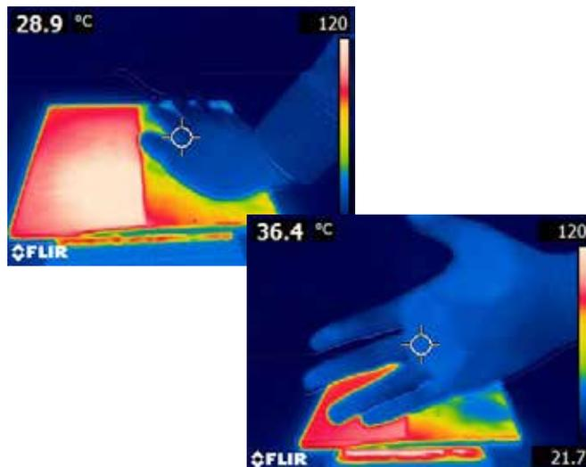
Une couche unique de Belzona 5871 réduit les transferts thermiques et évite les brûlures thermiques
