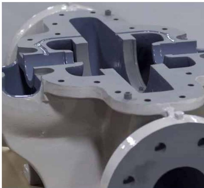
Belzona 5821 est un revêtement polyvalent appliqué au pinceau ou par pulvérisation, qui confère une protection exceptionnelle contre les effets du sel, de l'eau, des acides, des alcalins, des alcools et des hydrocarbures.
