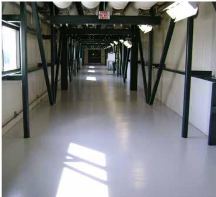
Belzona 5231 (SG Laminate) est un système de revêtement liquide bi-composants conçu pour les sols nécessitant une résistance aux produits chimiques et à l'abrasion ainsi que des propriétés antidérapantes.
