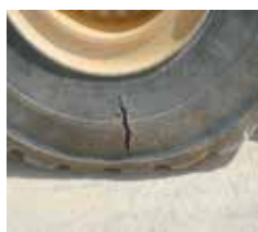
Fissure et déchirure réparées
