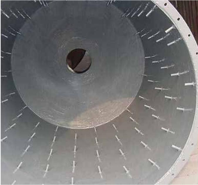
Belzona 1392 (Ceramic HT2) est un système de revêtement haute température à deux composants conçu pour résister aux hydrocarbures et aux solutions aqueuses. Ce produit est spécialement conçu pour présenter une excellente résistance aux produits chimiques, en particulier dans les systèmes contaminés par des acides. Il confère aussi une excellente résistance à l'érosion.
