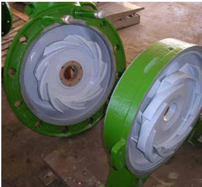
Belzona 1341N (Supermetalgilde) est un système de revêtement bi-composants conçu pour améliorer le rendement de l'équipement de traitement de fluides et protéger les métaux contre les effets de l'érosion et de la corrosion.
