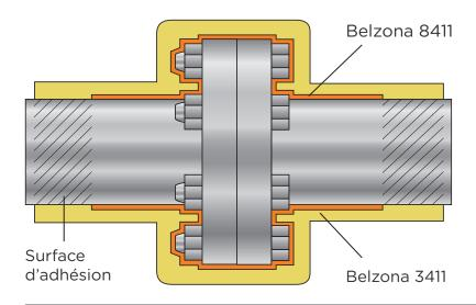
Le système de protection de bride Belzona est une combinaison de deux produits:
