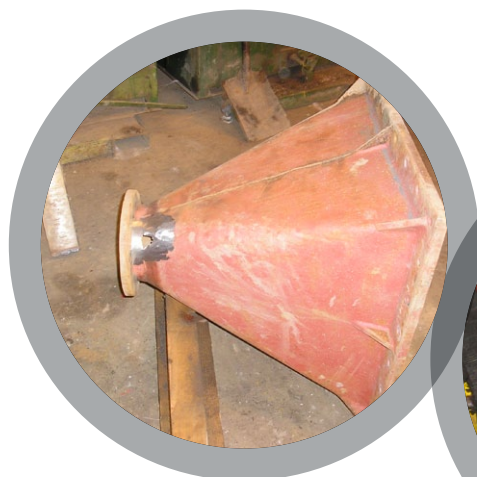
Étanchéité de trémies fuyantes
